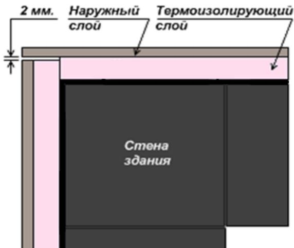
Монтаж начинаем с установки плит на углах по отвесу.
